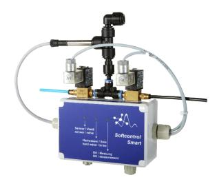
Überwachen Sie stets einfach und genau das Weichwasser auf erhöhte Härtekonzentrationen. Es bietet eine kontinuierliche, sichere Grenzwertüberwachung mit Alarmierung bei Überschreitung. Beim festen Härtegrenzwert von 10 % bezogen auf die Eingangswasserhärte löst das Gerät Alarm aus.
